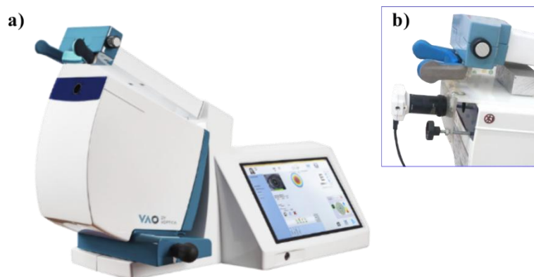
Figura 2.6: a) Simulador visual de óptica adaptativa comercial (VAO, Voptica, SL, Murcia, España) [Voptica, n.d]. b) Ojo artificial acoplado a instrumento.
