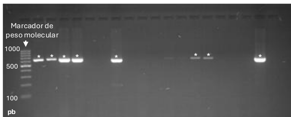
Figura 19. Imagen de un gel de agarosa cargado con ADN amplificado obtenida a partir del equipo DNR MiniBis Pro transilluminator (312 nm) (DNR Bio-imaging, Jerusalén, Israel).
