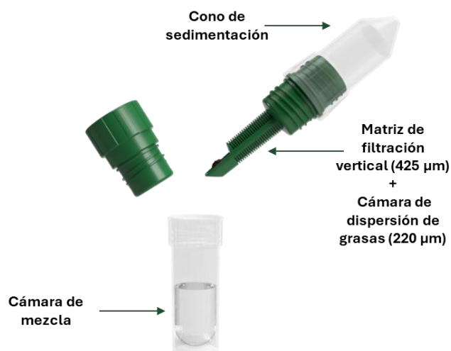
Figura 18. Sistema de concentración y filtrado de heces MidiParasep® Solvent Free de 50 mL (Apacor, Wokingham, UK) (Modificado de: Apacor, s.f.).
