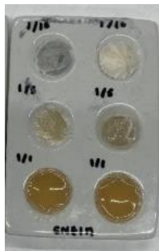
Figura 23. Resultados de pruebas de polimerización en masa en placas de porcelana.
