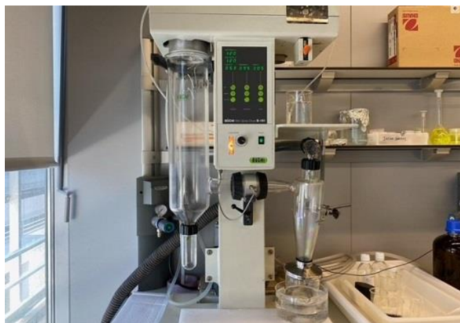
Figura 18. Spray dryer a escala laboratorio utilizado para la encapsulación de enzimas mediante el método de spray drying.
