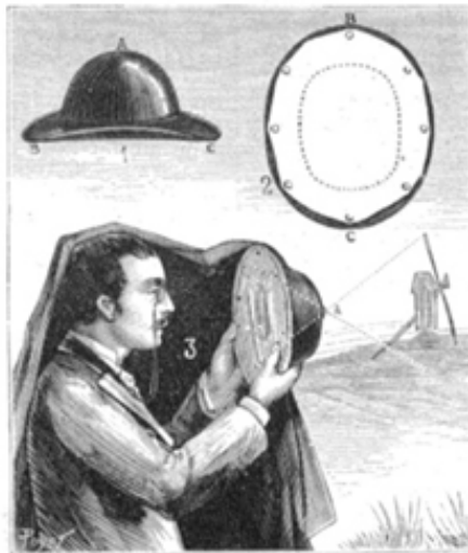
Fig. 1. — Chambre noire faite avec un chapeau rond.
