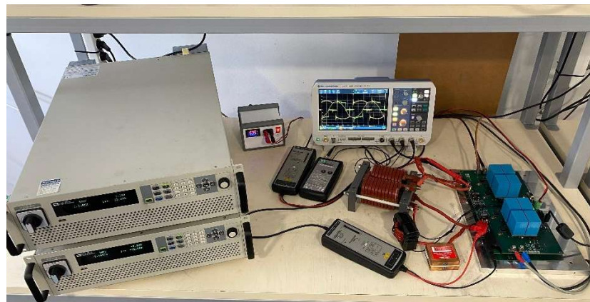
Figura 47. Banco de pruebas del DAB resonante con el inductor variable.
