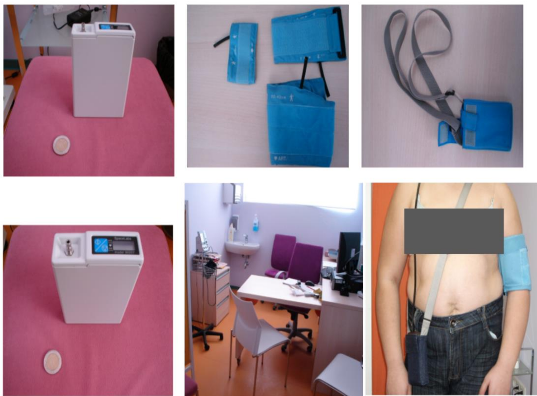
Figura 33. Monitor oscilométrico Spacelabs 90207. Se muestra el software, el manguito y el módulo portátil.
