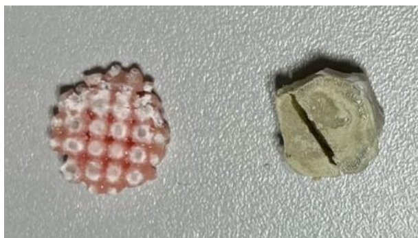
Figura 38: Fotografía de una pieza del modelo B (izquierda) y modelo D (derecha) fabricadas con 2 g de amoxicilina-clavulánico y tras la elución de los fármacos durante 7 días a las que se les ha aplicado la fuerza de rotura.
