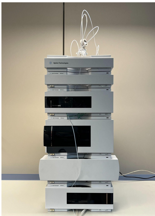
Figura 13: Equipo modular de cromatografía líquida de alta eficiencia (HPLC) 1200 series® (Agilent Technologies) utilizado para identificar y cuantificar la amoxicilina y el ácido clavulánico.
