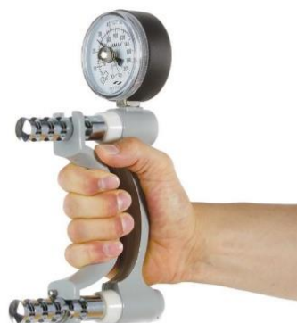
Figura 17. Dinamómetro de mano análogo Jamar ( Saehan Hydraulic Hand Dynamometer, 0-90kg ).
