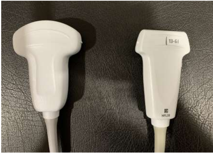
Figura 31. Transductores convexo de 2 a 5 MHz y lineal de 6 a 13 MHz (SonoSiteInc, Bothell, USA).
