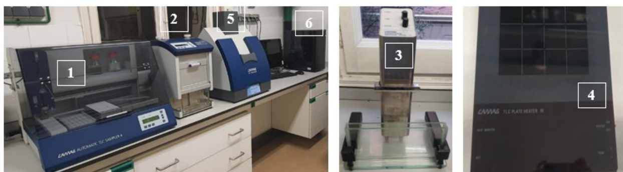
Figura 28. Sistema semiautomático Camag. Aplicador (1); cámara de desarrollo (2); dispositivo automatizado de inmersión (3); placa calefactora (4); sistema visualizador (5); documentación ( Software ) (6).
