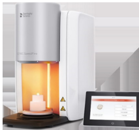
Figura 34: Horno de sinterización CEREC SpeedFire (Dentsply Sirona®, Carolina del Norte, USA).
