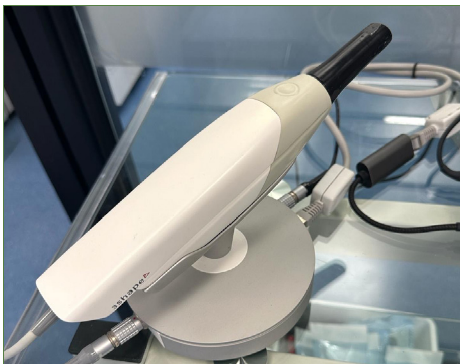
Figura 58: Sistema de escaneo intraoral Trios 3® (3Shape®, Copenhagen, Dinamarca).
