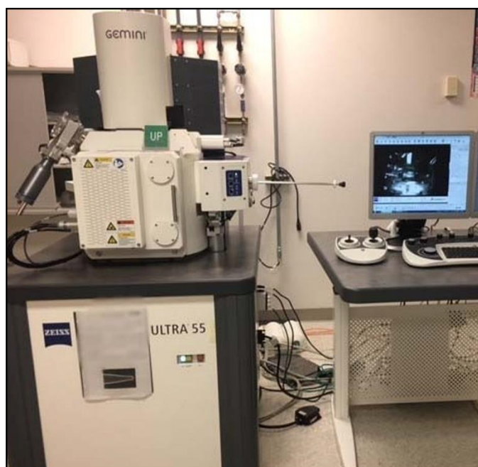
Figura 4.15: Microscopio electrónico FESEM Zeiss Ultra-55
