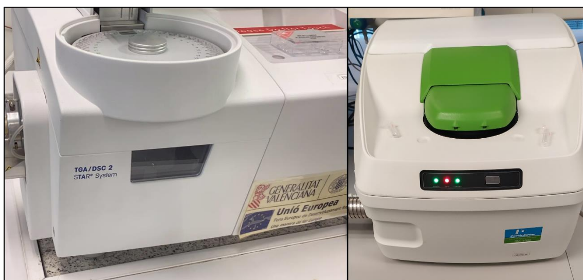
Figura 4.9: Instrumentación utilizada en los estudios térmicos. A la izquierda el equipo de análisis termogravimétrico utilizado. A la derecha el calorímetro diferencial de barrido.
