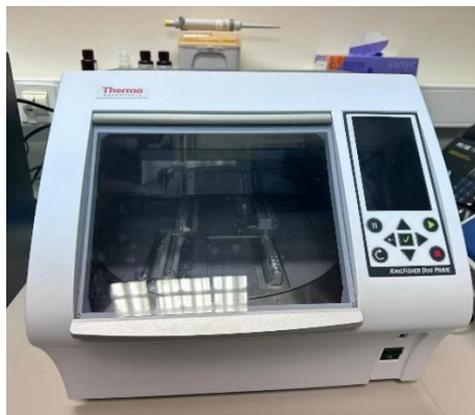
**Figura 31.** Thermo Scientific™ KingFisher™ Duo Prime Purification System. Instrumento de purificación ofrece una producción de alta calidad de ácidos nucleicos (ADN/ARN) y proteínas. Extrae ADN y ARN de las células para la realización de RT-PCR y otros. Fotografía tomada del laboratorio.
