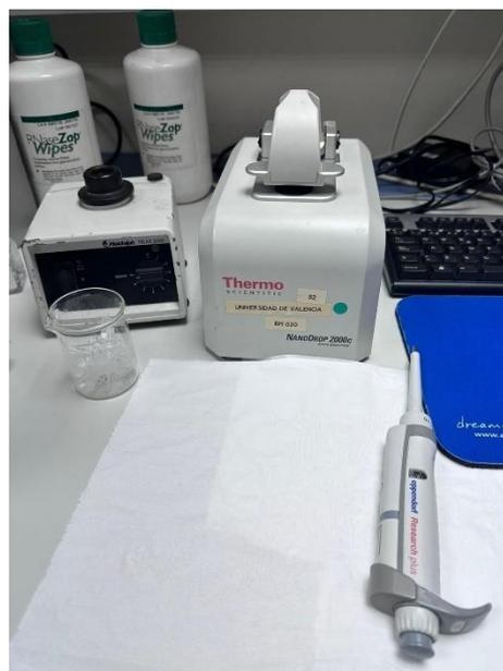
**Figura 32.** Espectrofotómetros NanoDrop™ 2000/2000c, Thermo Scientific™. Dispositivo diseñado para medir y analizar la luz en función de su longitud de onda, para medir cantidad de material genético de una muestra. Fotografía tomada del laboratorio.
