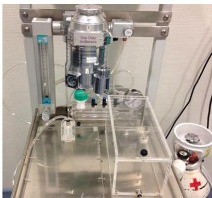
**Figura 28.** Vaporizador de anestesia y cámara estanca. Los animales fueron anestesiados con isoflurano. Se situaban dentro de una cámara estanca con entrada de oxígeno y una atmósfera de Isoflurano al 5% generada por un vaporizador (Harvard Apparatus). Tras unos minutos los animales quedaban dormidos. Fotografía tomada en el Dpto. Farmacología, Facultad de Medicina, Universidad de Valencia.
