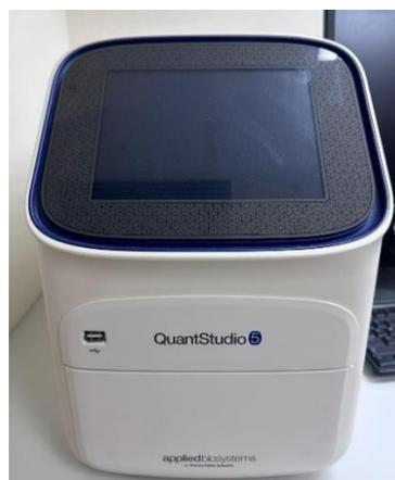
**Figura 30.** Sistemas de PCR en tiempo real QuantStudio 5, Applied Biosystems, Thermo Fisher Scientific. Fotografía tomada del laboratorio.
