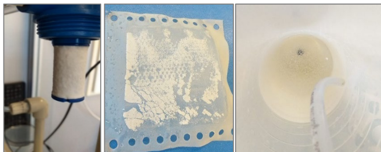
Figura 5.3. Precipitados encontrados en el equipo de ED tras la realización de ensayos de larga duración: a) filtro del compartimento concentrado en la entrada de la celda de ED; b) membrana de intercambio catiónico; c) depósito de concentrado.
