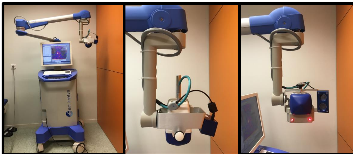
Figura 6. Gammacámara portátil Sentinella ® 102; Pinhole+colimador+cámara óptica.
