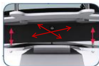
Figura 63 - Movimientos de la plataforma para su calibración
