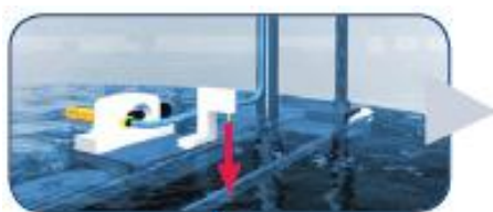
Figura 64 - La imagen 2a muestra el sensor que tiene la barra para detectar el agua y en la imagen 2b se muestran los tres puntos con los que determina el cero superficie.
