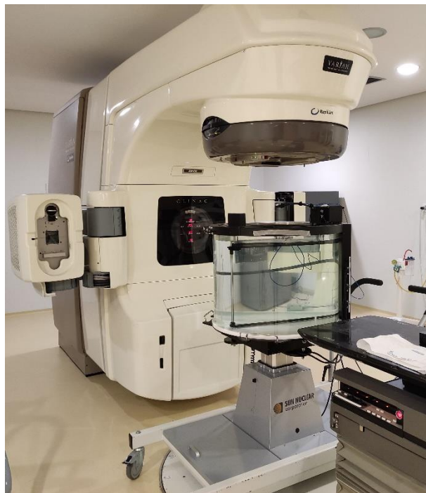
Figura 9 - Detalle del 3D-Scanner en el búnker de Radioterapia del Hospital IMED Elche listo para tomar medidas. @ Cortesía del autor
