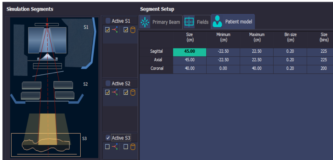
Figura 73- Segmento s3 donde se muestra la definición del fantoma de agua empleado y el tamaño mínimo (bin) donde se va a realizar la simulación
