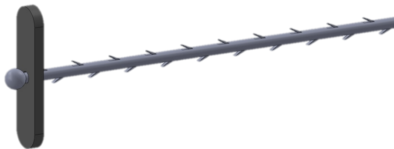
Figura 44. Detalle (modelado 3D) de la unión del implante con el hilo barbado
