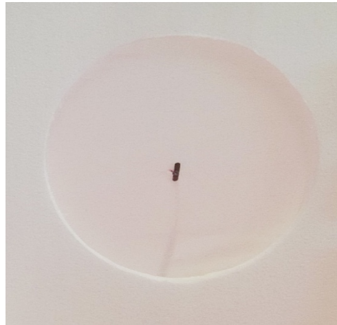
Figura 42. Cierre de la perforación por el implante observado en los test sobre membrana de látex suspendida
