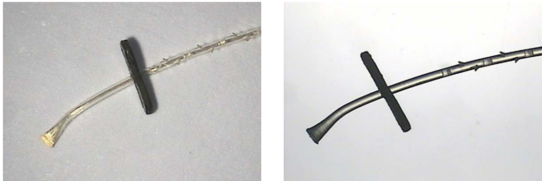
Figura 59. Detalle de la zona de contacto entre hilo barbado y parche tras deformación térmica
