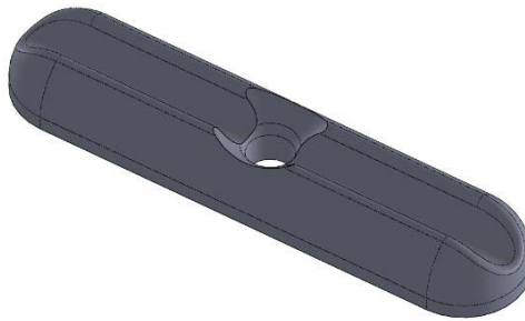
Figura 77. Rebaje longitudinal sobre el implante para el paso del hilo durante la transferencia
