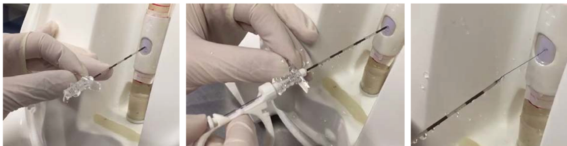
Figura 71. Secuencia de retirada de aguja y soporte de transferencia tras punción sobre membrana sintética
