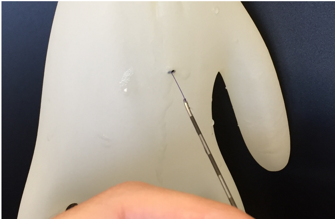
Figura 41. Retirada de aguja dejando hilo e implante en el sitio de perforación en test de laboratorio sobre membrana -guante- de látex
