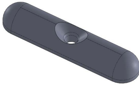
Figura 76. Detalle del alojamiento cónico en torno al ojal para el encaje del tope del hilo
