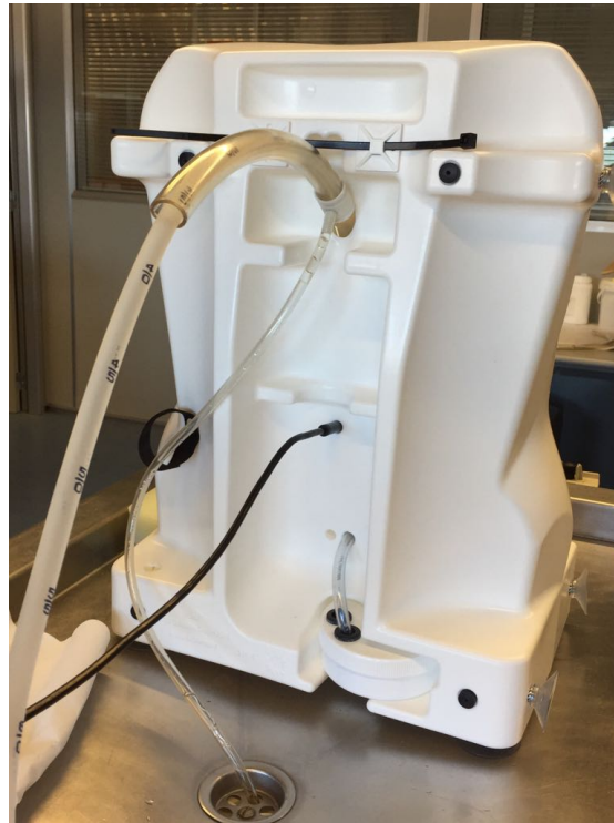
Figura 47. Montaje adaptado del simulador de punción epidural para la realización de pruebas de validación funcional
