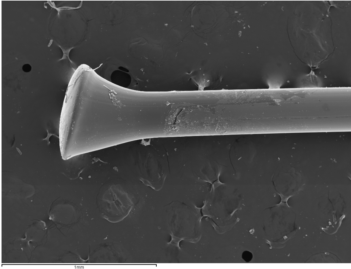
Figura 45. Visión lateral con microscopio electrónico a 50 aumentos de un hilo de sutura tras deformación térmica sin contacto en una de las pruebas realizadas
