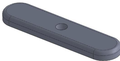
Figura 74. Implante base con una cara plana y otra redondeada por exigencias del molde
