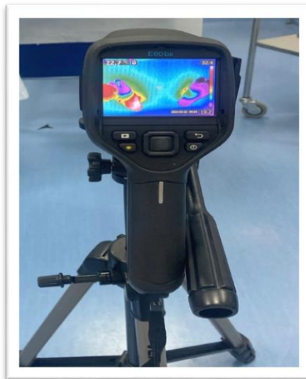
Figura 5: Cámara termográfica FLIR E60 1.0 (USA) y trípode.
