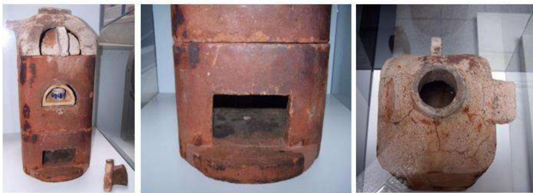
Fig.97.Horno de pruebas combustible vegetal. Marca Cucurny, Barcelona 1890-1920 Refractario. Conservado en el MCM.
