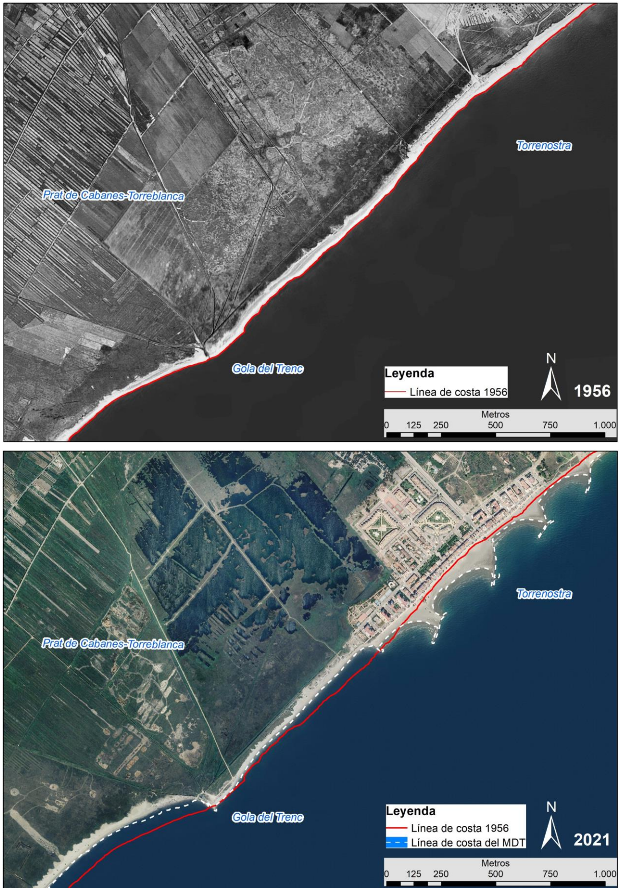
Figura 84. Secuencia del retroceso de la costa al sur de los espigones de Torrenostre entre los años 1956 y 2021. La línea de costa en 1956 se representa en rojo (arriba, ortofoto de 1956, CNIG) y la del año 2021 a partir de una línea de trazo discontinuo de color blanco (abajo, ortofoto de 2021, IDEV).
