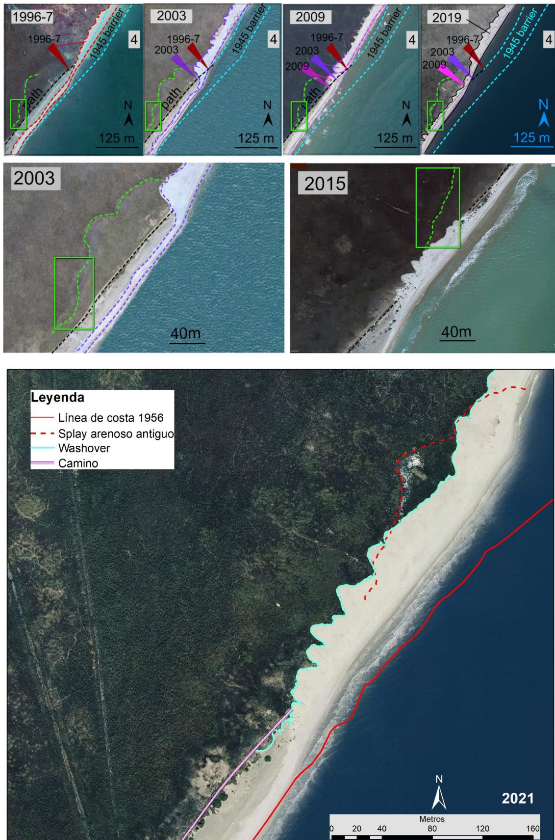
Figura 86. Evolución de procesos de rollover al norte de la Sèquia Vella (secuencias 1996 - 2019 de Carmona et al., 2020). Línea de costa de 1956 en rojo (continua), washover fans en celeste, camino de referencia en rosa (en la secuencia 1996 - 2019 es negro) y splay arenoso de referencia representado con línea roja discontinua (en la secuencia 1996-2019 es en verde). (Ortofoto de 2021, IDEV).
