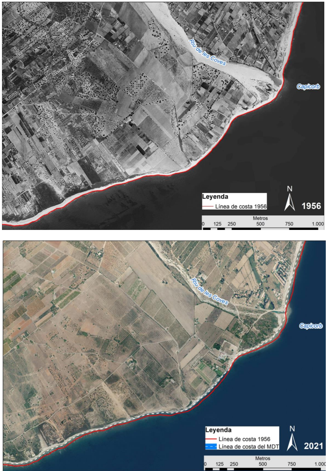
Figura 83. Secuencia del retroceso gradual de la línea de costa del cono aluvial del riu de les Coves entre los años 1956 y 2021. La línea de costa en 1956 se representa en rojo (arriba, ortofoto de 1956, CNIG) y la del año 2021 a partir de una línea de trazo discontinuo de color blanco (abajo, ortofoto de 2021, IDEV).
