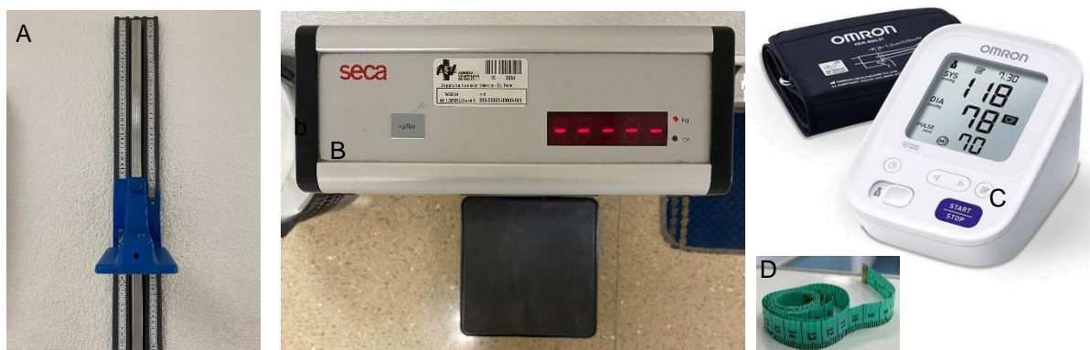
Imagen 2. Herramientas utilizadas para la antropometría. A: Tallímetro Seca® colocado de forma fija en la pared para medir la talla; B: báscula Seca® digital de columna modelo 727 (puesta en kg, con dos decimales); C: tensiómetro Omron® modelo m3 empleado para medir SBP y la DBP y D: cinta métrica para el perímetro de la cintura y de la cadera.
