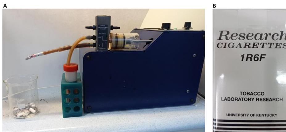
**Figura 15. Preparación del extracto de humo de tabaco (EHT) utilizado como estímulo en los experimentos *in vitro*.** A) Bomba de respiración de animales utilizada para generar el EHT y burbujearlo en el medio de cultivo. B) Cigarrillos de investigación 1R6F utilizados para la preparación del EHT.
