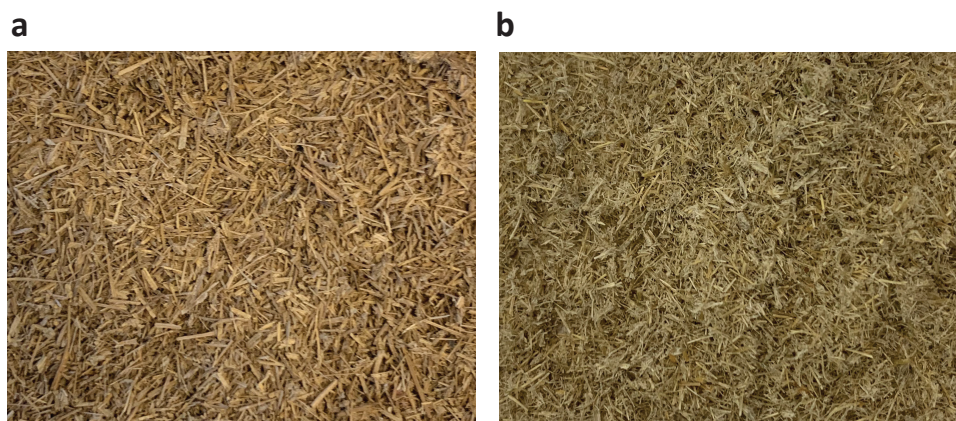
Figura 5.3. Paja de arroz pretratada con microondas (a) y con hidróxido sódico (b).
