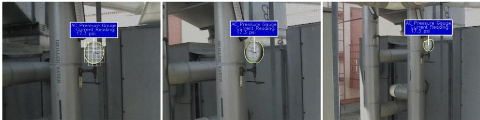
Figura 2.25. Sistema de Realidad Aumentada con seguimiento basado en flujo óptico. Fuente: (Mooser et al., 2007)
