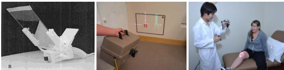
Figura 2.8. Ejemplos de dispositivo óptico de mano (izquierda, fuente: (Stetten et al., 2001)) y de proyectores de mano para los sistemas de Realidad Aumentada iLamps (centro, fuente: (Raskar et al., 2006)) y AnatOnMe (derecha, fuente: (Ni et al., 2011))
