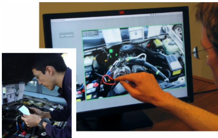
Figura 2.41. Un usuario remoto (derecha) dibuja un trazo sobre un elemento del entorno. El usuario local (izquierda) ve la anotación en tiempo real mediante Realidad Aumentada.
