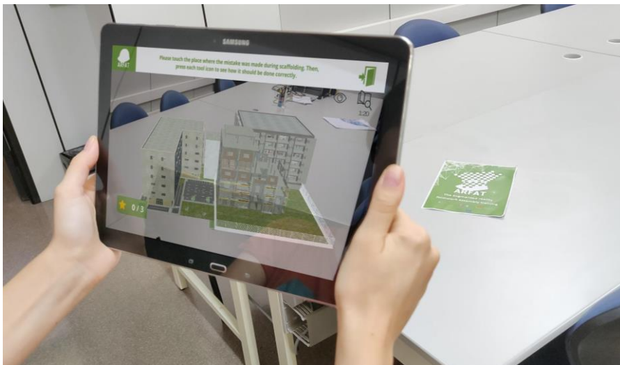
Figura 2.22. Sistema de Realidad Aumentada con seguimiento basado en características. Fuente: (García-Pereira et al., 2019)
