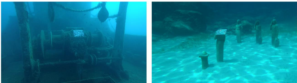
Figura 2.21. Marcadores para sistemas de Realidad Aumentada en entornos desfavorables. Fuente: (Cejka et al., 2018)
