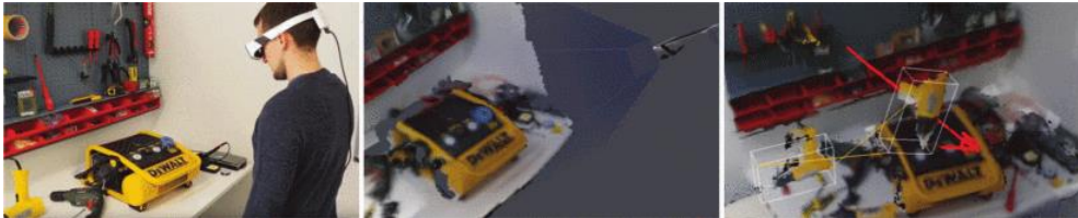
Figura 2.42. Un trabajador local con un HMD (izquierda) genera un modelo 3D del entorno de trabajo (centro). Un experto remoto usa la malla resultante para crear instrucciones (derecha). Fuente: (Zillner et al., 2018)
