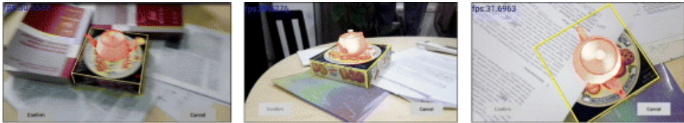
Figura 2.26. Sistema de Realidad Aumentada con seguimiento híbrido. Fuente: (Yang et al., 2018)
