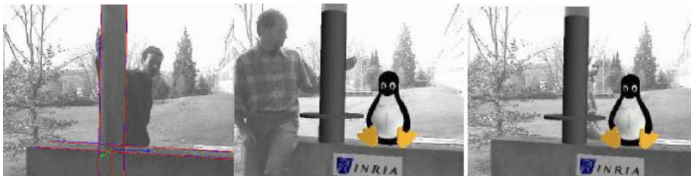
Figura 2.23. Sistema de Realidad Aumentada con seguimiento basado en modelos. Fuente: (Comport et al., 2003)
