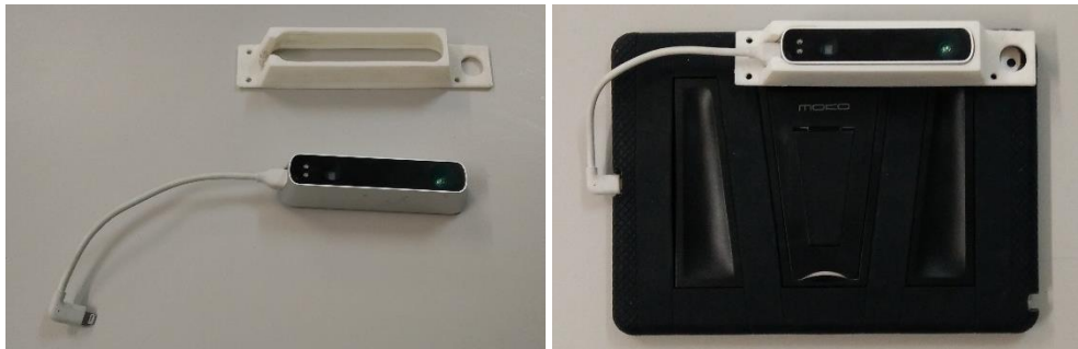
Figura 4.7. Carcasa 3D y Structure Sensor (izquierda); montaje final sobre la carcasa de goma (derecha)
