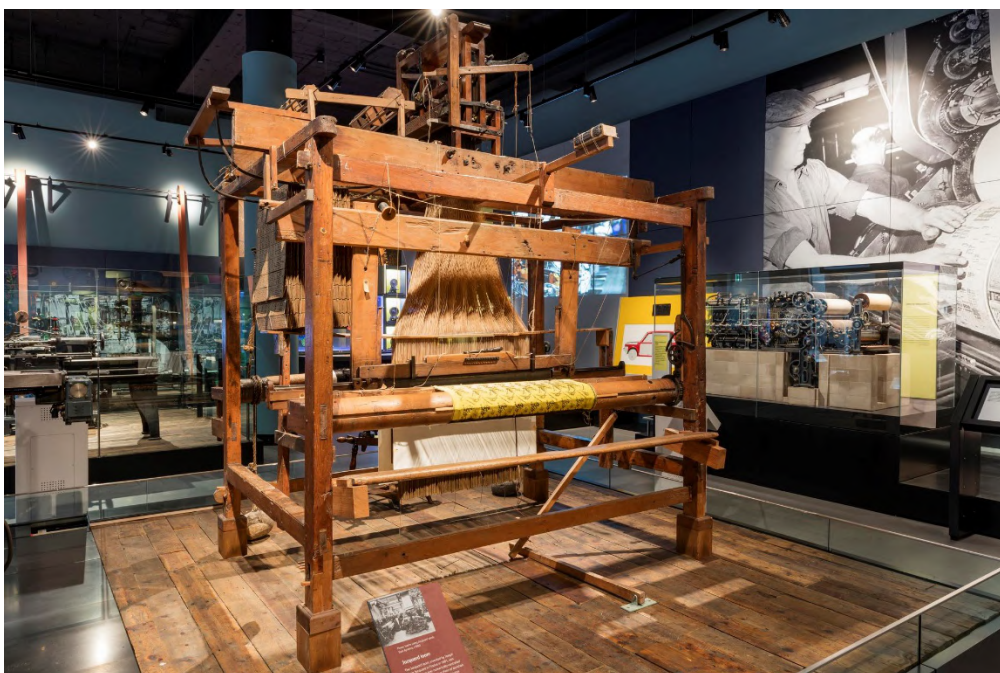
Figura 76. Telar de seda con un añadido Jacquard. Presenta un pañuelo de seda en la máquina en proceso de fabricación, probablemente hecho por Joseph Hood de Newmilns, Ayrshire, S. XIX. © National Museums Scotland. N° Inv. T.1934.241
