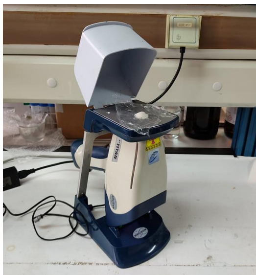
Fig. 10 - Espectrómetro pED-XRF S1 Titan en condiciones de medida.
