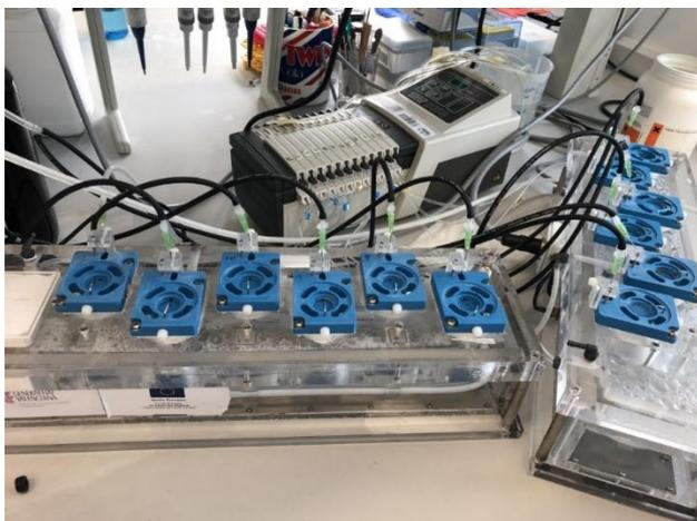
**Figura 21. Sistema de perfusión.** Los cortes frescos de cerebelo se colocan en unos pocillos que están conectados a una bomba de perfusión que va perfundiendo tampón Krebs con el tratamiento correspondiente y a un sistema de vacío que elimina el exceso de líquido para asegurar su regeneración.
