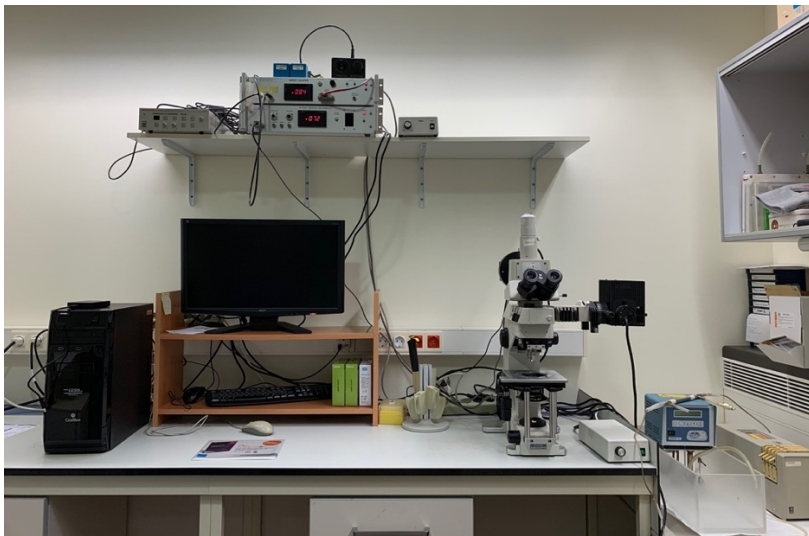
Figura 43. Sistema de microscopía intravital. La imagen muestra los diferentes componentes del sistema de microscopía intravital. De izquierda a derecha en la parte superior: Optical Doppler Velocimeter y equipo de iluminación. De izquierda a derecha en la parte inferior: ordenador donde se visualizan las imágenes y vídeos con el programa NIS-Elements Basic Research , microscopio con videocámara acoplada, baño termostático y bomba de infusión.
