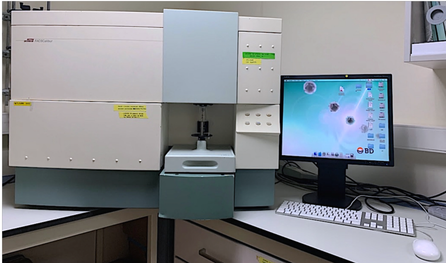
Figura 37. Equipo de citometría. De izquierda a derecha: citómetro (modelo BD FACSCalibur™ de BD Biosciences), tubo de citómetro y pantalla de ordenador con el software BD CellQuest™ Pro.
