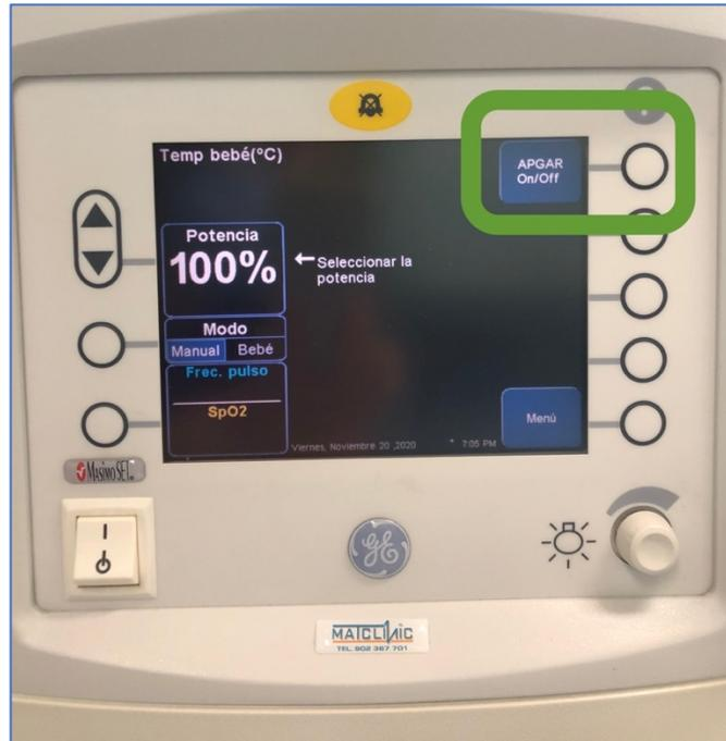
*Figura 12: Reloj temporizador Apgar de la Cuna Térmica Giraffe ® (General Electric Healthcare). Fuente: Elaboración propia.*
