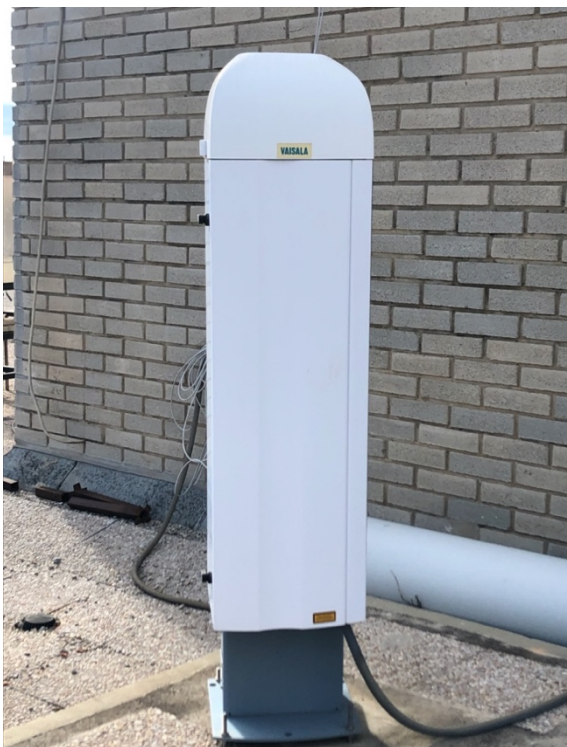
Figure 2.11 : Ceilometer CL-51 (Vaisala)
